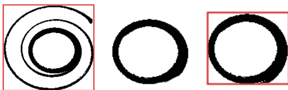
a 恒力弹簧外径测量 b 恒力弹簧内径提取 c 恒力弹簧内径测量 图2 恒力弹簧内外径测量
