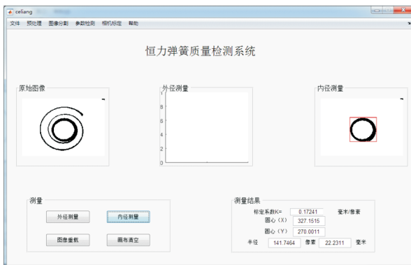
图7 检测系统内径检测界面
