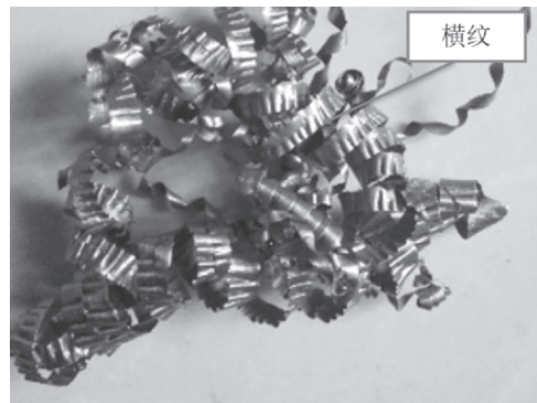
图9 枪钻磨损后的切屑
