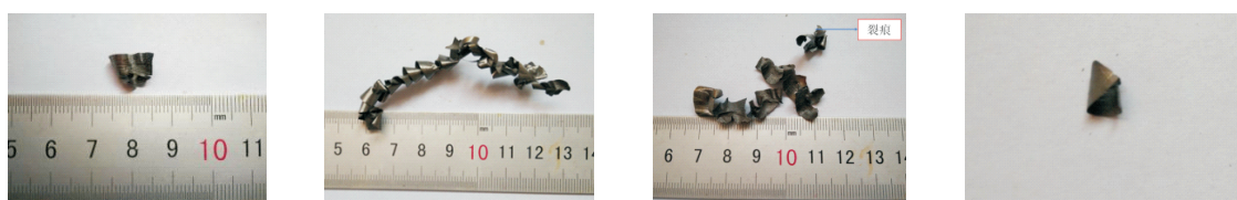
(a) 单元切屑 (b) 带状切屑 (c) 挤裂切屑 (d) 崩碎切屑
