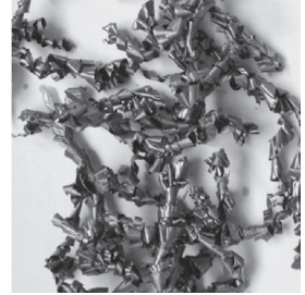
图13 高速低进给短屑
